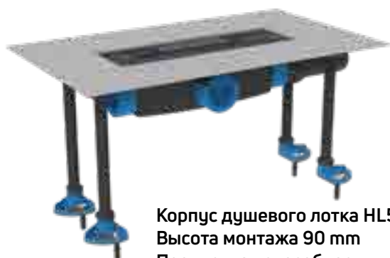
Корпус душевого лотка HL53.0 Высота монтажа 90 мм Пропускная способность = 0,83 л/с
